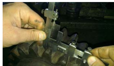
Фиг.5. Измерване дебелината S_b на зъб от зъбно колело.
