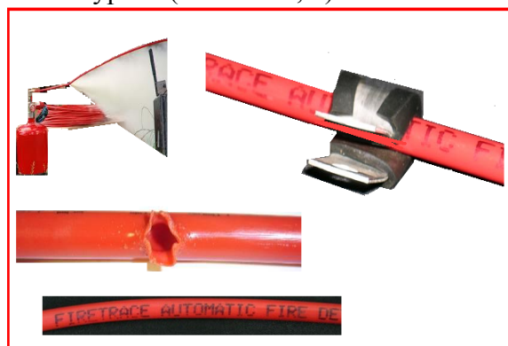
Фиг.6, б За охрана на линейни обекти се използват огнегасителни шнурове FIRETRACE (Тръбичката се спуска, когато температурата на средата достигне 373 К, при което формира изходна дюза за изтичане на огнеподтискащия газ).
