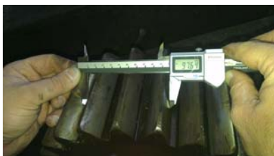
Фиг. 4. Измерване на дължината на общата нормала, W_m на зъбно колело.
