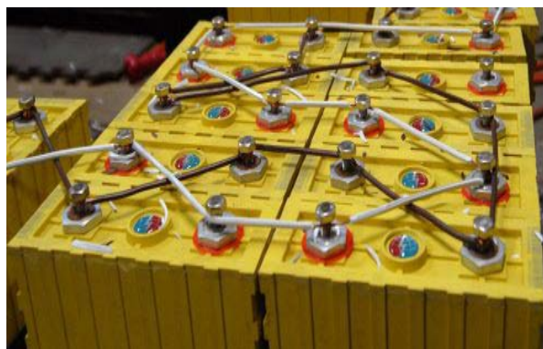
Фиг. 3 Двупроводна мрежа за предварително балансиране на призматични клетки високо SOC в клетките с по-ниско SOC. На фиг. 3 е показана дву-проводна мрежа за изравняване на клетките с кабели и пръстен-терминали. След изравняването целия
