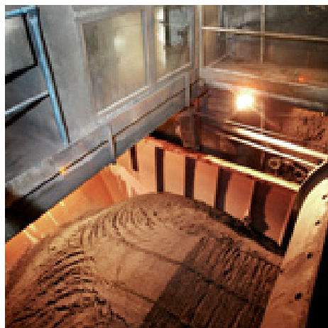
Фиг.1 Товарни вагони за руда изработени от стомана Weldox 700 чрез лазерно - хибридно заваряване от фирма SSAB, Швеция
