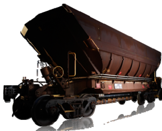
Фиг.1 Товарни вагони за руда изработени от стомана Weldox 700 чрез лазерно - хибридно заваряване от фирма SSAB, Швеция
