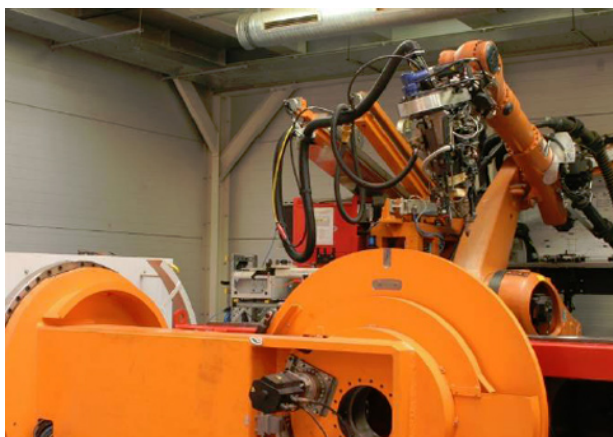
Фиг.2 Апаратура за лазерно хибридно заваряване използвана от Сименс при производството на локомотива „Вектрон”
