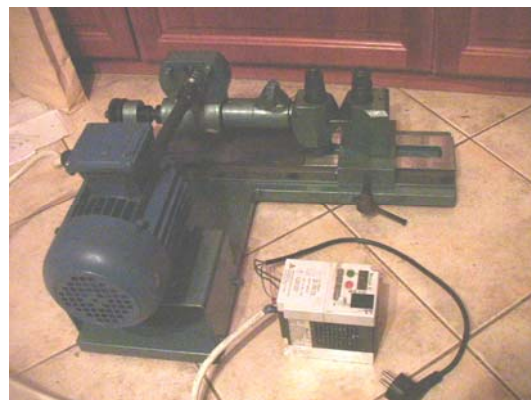
Фиг. 2. Резонансен вибратор: 1/ Честотен модулатор Moeller DF51-320. 0 до 125 Hz. 150 Hz = 3000 об., 2/ чугунена направляваща, 3/ неподвижна челюст, 4/ двигател модел Miksan тип Type 71 6B, 50 Hz, 0,25kW, 5/ дебалансно устройство, 6/ буфер, 7/ вибриращо устройство, подвижна челюст.
