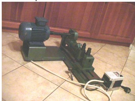
Фиг. 2. Резонансен вибратор: 1/ Честотен модулатор Moeller DF51-320. 0 до 125 Hz. 150 Hz = 3000 об., 2/ чугунена направляваща, 3/ неподвижна челюст, 4/ двигател модел Miksan тип Type 71 6B, 50 Hz, 0,25kW, 5/ дебалансно устройство, 6/ буфер, 7/ вибриращо устройство, подвижна челюст.
