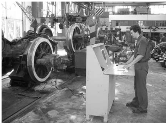
Рис.1. Диагностирование колесно-моторного блока локомотива с помощью стационарного комплекса «Прогноз-1М»
