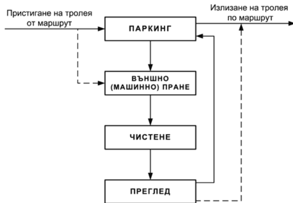
Фиг. 5 Схема на движение на тролея при дневен преглед
